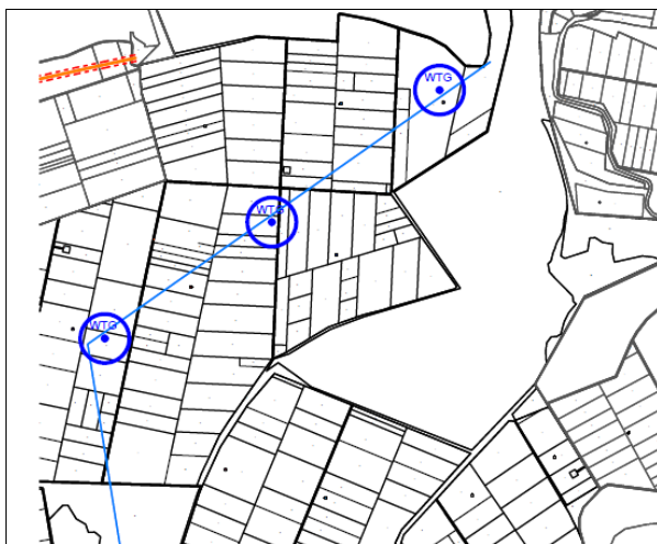
Фигура 14 Отпадащи турбини попадащи в близост до водопровод
